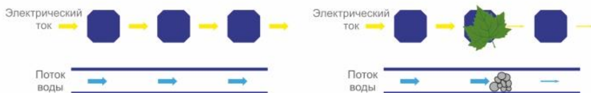
13-сурет - Көлеңкеленген күн элементі бүкіл тізбек бойынша энергия ағынын бұғаттау имитациясы
